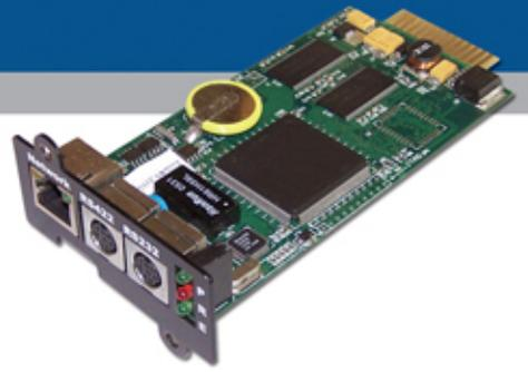
PowerNET为UPS与网络之间的通信与连接建立了一个平台。用户可以通过PowerNET查看UPS当前的工作状态及参数,比如输入电压、输入频率、输出电压、电池电压、电池容量、当前负载、工作模式等;还可以通过PowerNET向UPS发送开/关机指令。用户可以通过对特定事件,比如输入电压过低或负载达到一定数值,设定UPS的响应。用户还可以自己编辑计划任务,比如某天或一周/月当中的某天定时关机、当前状态下某段时间后关机或关机后重新开机等等。
